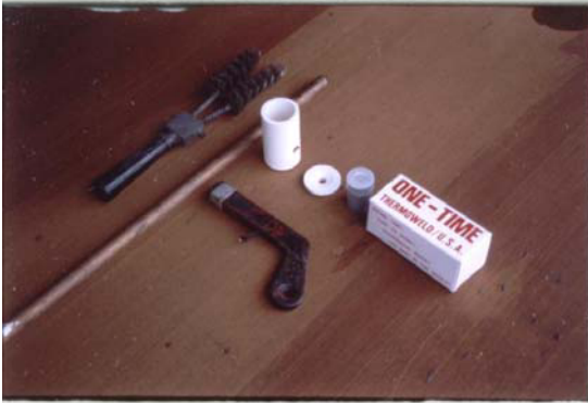
รูปที่ 1.1 เตรียมอุปกรณ์ในการเชื่อมด้วยความร้อนให้พร้อมซึ่งประกอบด้วยแม่พิมพ์ในการเชื่อม ผงเชื่อม ปืนจุดระเบิด เป็นต้น
